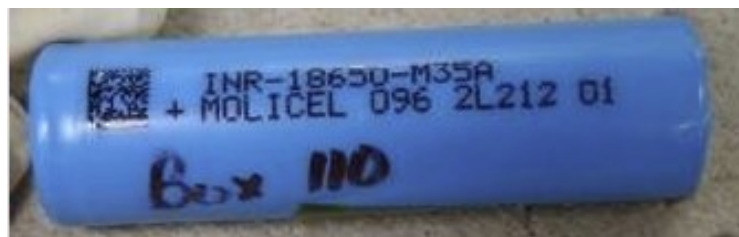
Abbildung 2: Molicel INR18650-M35A Zelle bei der NASA [16]. Technische Details zu Design und Performance können aus [16] entnommen werden.
